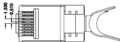
Conector macho RJ45 8P8C Cat7 FTP con guía, para uso con cables rígido o cable flexible sin apantallamiento.
